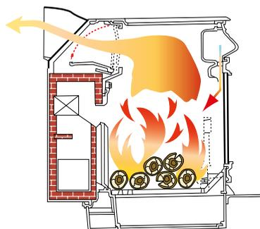
Le clapet est ouvert, le thermostat est réglé de façon à permettre l'arrivée d'une grande quantité d'air. Il faut laisser chauffer le poêle, avec un bon lit de braises, jusqu'à obtenir une température de plus de 260°C.
