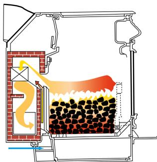
La combustion des gaz volatiles est quasi complète. Le dégagement de chaleur se poursuit de façon constante pendant plusieurs heures. Dès que le lit de braises diminue, ouvrir le clapet d'évacuation des fumées avant de recharger le bois.
